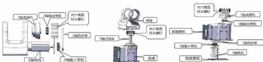
底座-转座部分 (1轴+2轴) 拆分方式
