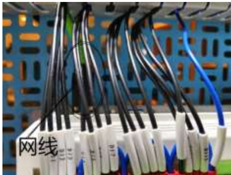
图 2-3 控制器与示教器通信安装示意图
