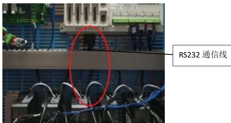
图 2-1 控制器与驱动器通信回路的安装示意图
