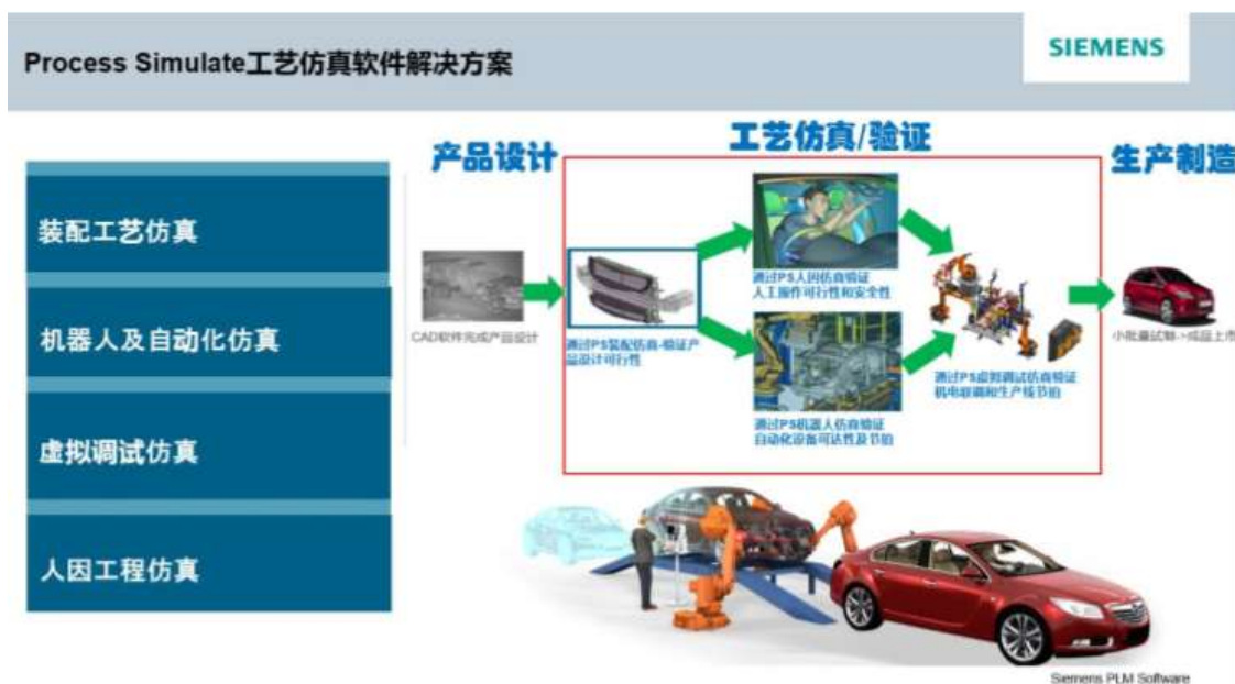
图 1-1 PS 软件各主要功能模块及在 PLM 中所起的承上启下的作用
